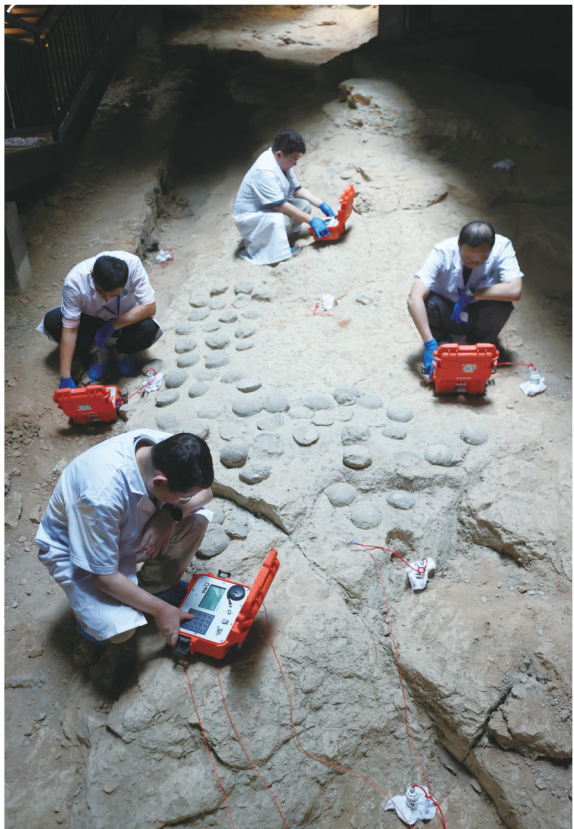
联合科研团队在青龙山恐龙蛋遗址馆内进行IRIS-FW全波形激电仪信号接收前调试。
