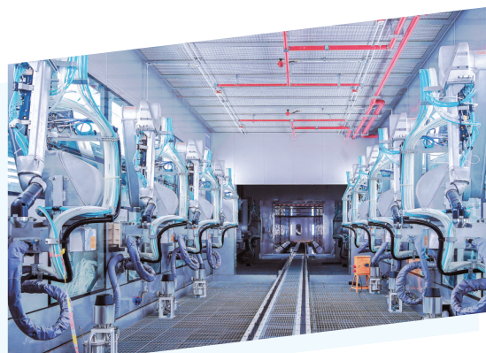
涂装车间实现智能机器人喷涂。
