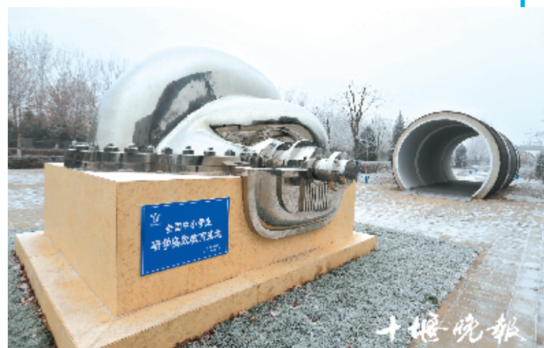
惠南庄管理处前放置的水泵模型和输水PCCP管。
