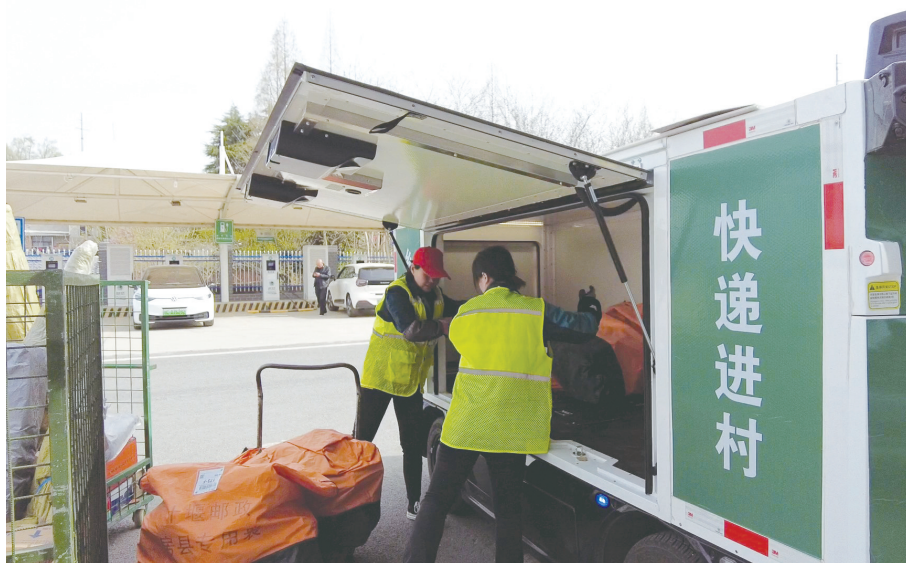
工作人员将快递放进无人快递配送车,通过手机App进行扫码、设定线路等步骤过后,配送车便启动送货。
