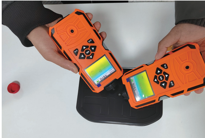
手持式可燃气体检测仪测出自热火锅加热过程中产生可燃气体。
