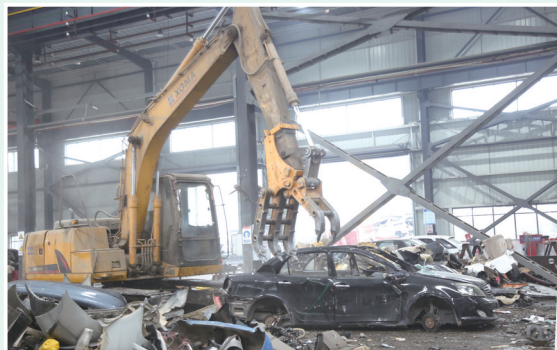
破坏性拆解最终得到废钢。
