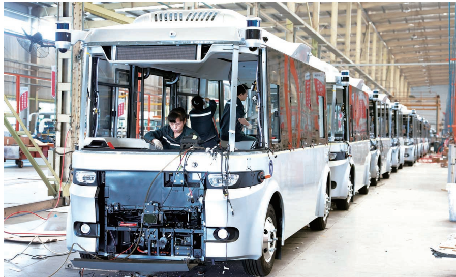
在东风特种汽车有限公司生产车间里,工人正在装配无人驾驶智能化微公交车。(资料图片)
