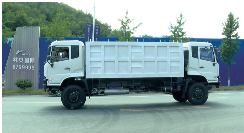
这辆“双头中重卡”无需调头就可以一键操作切换行进方向。
