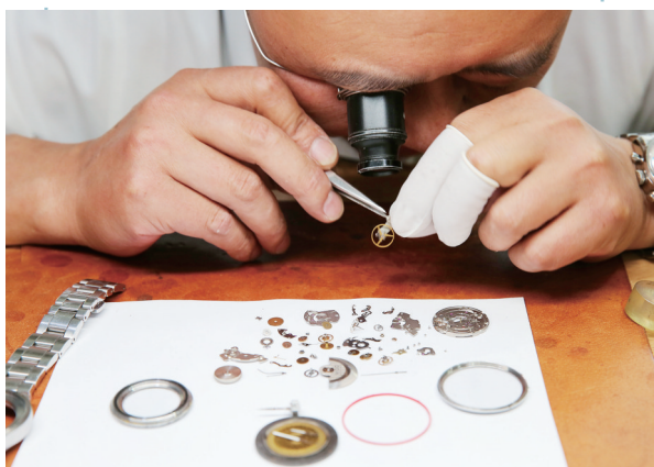
陈德斌戴上放大镜,手指戴上橡胶指套,反复查看从手表上拆下来的零件。
