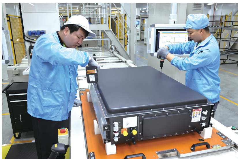
工作人员对即将下线的储能电池包进行组装。
