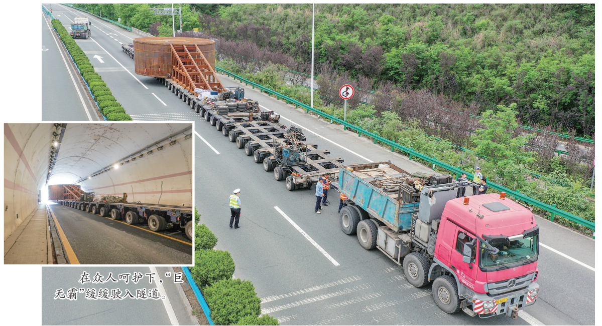
该特制车辆前后共有43个轴,每个轴有8个车轮,由两台重型牵引车前拉后推。
