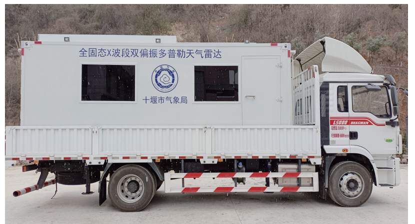
车载式多普勒天气雷达具有可移动、快速部署、跟踪观测等特点。
