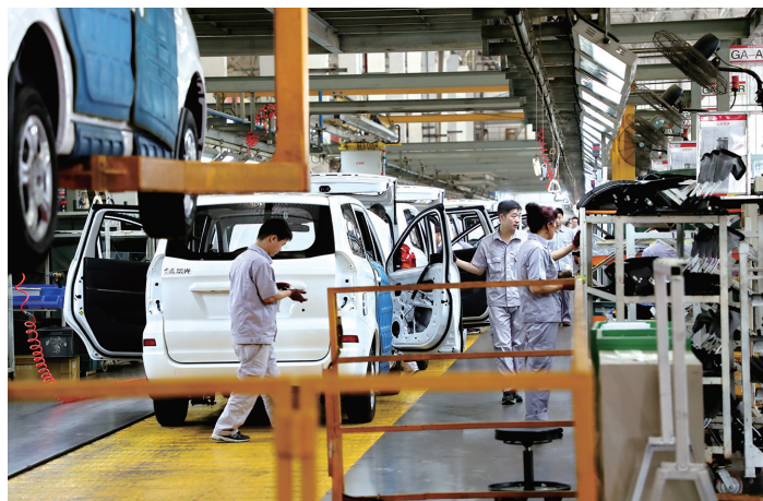
在总装车间,经冲压、焊装、涂装、总装等程序,平均一分钟可下线一台乘用车。
