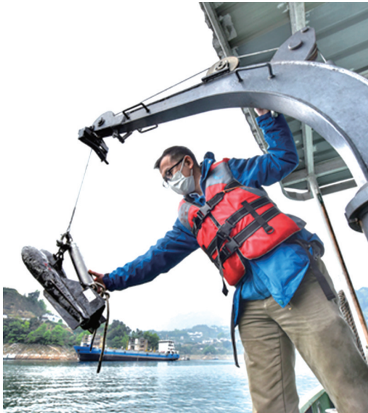
长江委水文局加快推进工程前期工作,在取水口用声速剖面仪校测水温。
