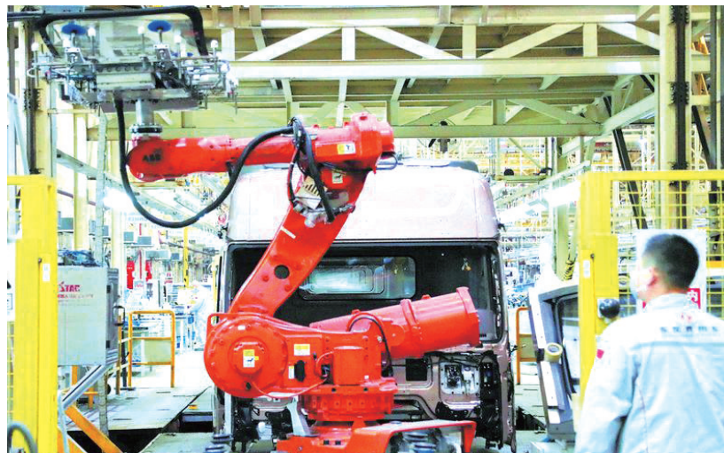
在东风商用车车辆工厂生产车间,机器人安装车身玻璃。
