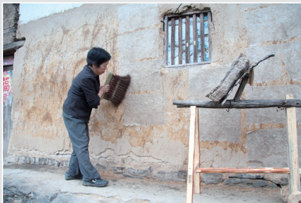
皮纸制作倒数第二个工序——晒纸。
