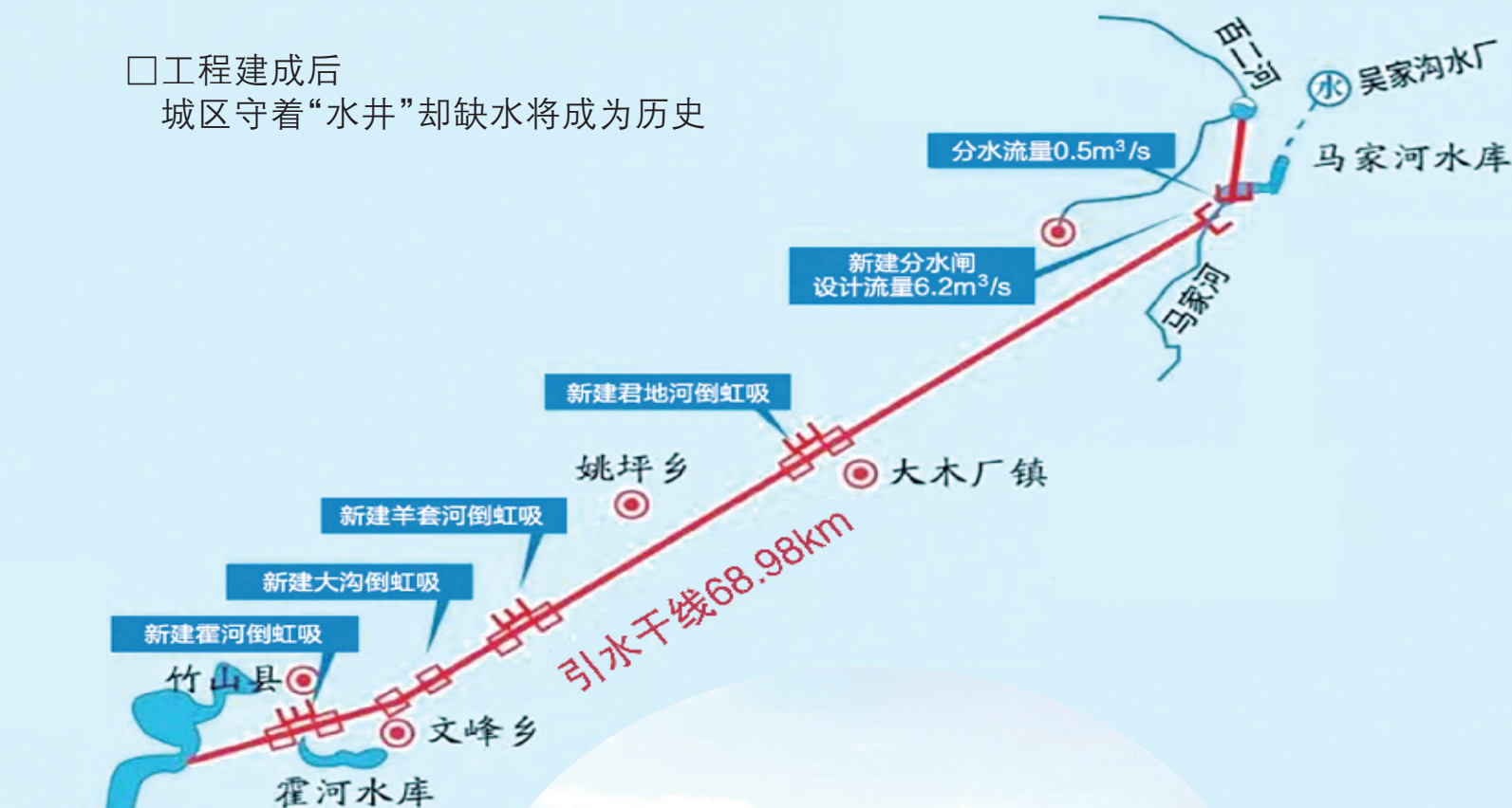
全程自流输水 汇入马家河水库。
