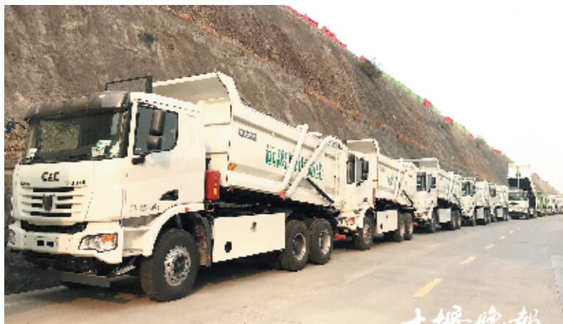
环保渣土车箱体全封闭,还能喷水抑尘。
